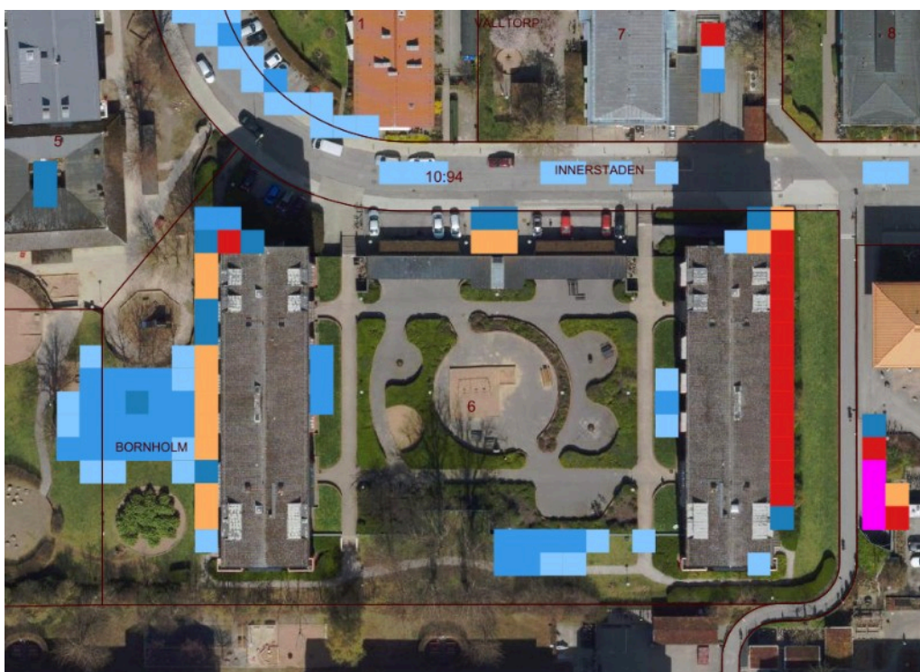
Simulering av markavrinning vid ett 100-årsregn, det vill säga var och hur djupt vatten samlas vid ett skyfall. (Malmö stad, 2109)
